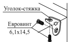
Схема 3. Установка уголка-стяжки
